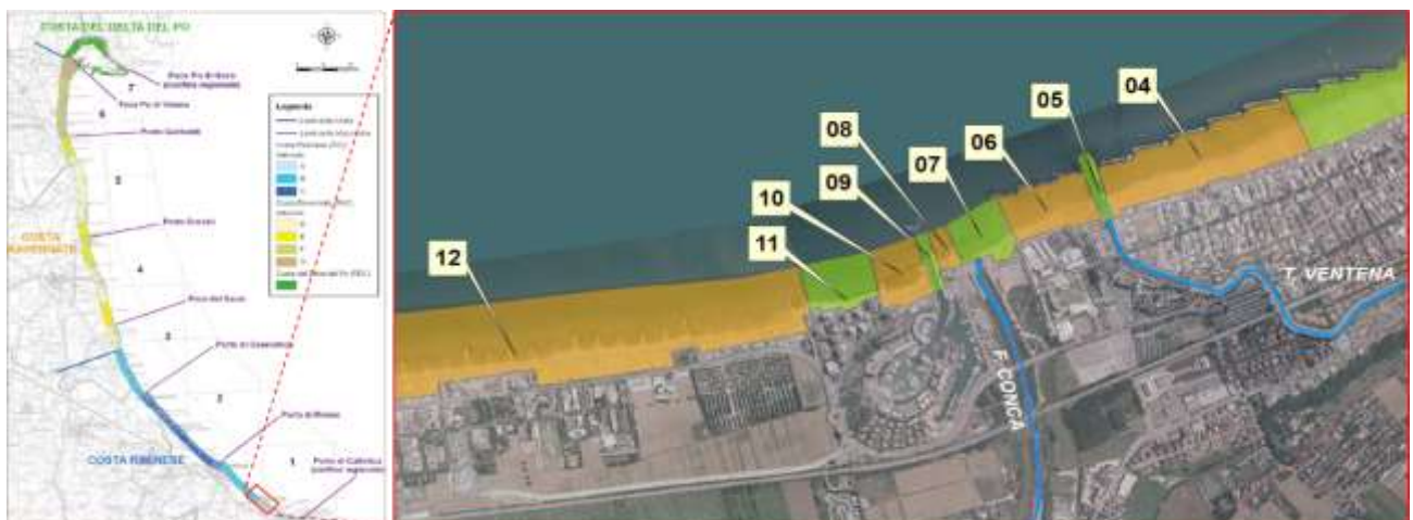
Figura 7: Suddivisione della costa regionale in 7 Macrocelle ed esempio della suddivisione in 118 Celle litoranee ai fini gestionali . Per ogni Cella è possibile definire lo stato di criticità, considerando tra gli altri fattori le perdite di volume della spiaggia emersa e sommersa interna. (fonte Regione Emilia-Romagna)
